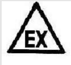
Locale con possibile presenza di atmosfera esplosiva
