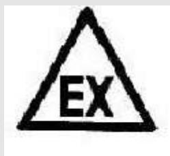
Locale con possibile presenza di atmosfera esplosiva
